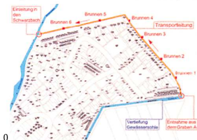
Abb. 2: Lokale Maßnahme zum Schutz gegen Vernässungen im Siedlungsbereich in Nauheim (Krs. Groß Gerau) (aus: HMUIRV 2005: Das Hessische Ried zwischen Vernässung und Trockenheit: eine komplexe wasserwirtschaftliche Problematik; S. 52)
